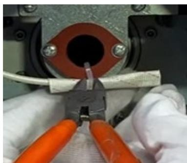
2. Снять винт и резиновый диск с кронштейна
