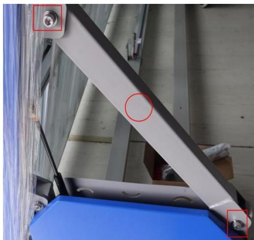
1. Снять поддерживающие балки с двух сторон.
