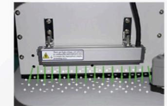
Для качественной печати на материалах, накапливающих электростатический заряд, и во избежание выхода из строя значимых дорогостоящих электронных компонентов принтеры оснащаются эффективными воздушными ионизаторами, установленными с двух сторон печатной каретки. Электростатический заряд может стать причиной таких недостатков, влияющих на качество изображения, как пыление чернил и отклонение капель от заданной траектории.
